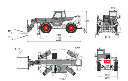
Correcteur de devers 4 roues motrices et directrices 2 vitesses de translation Ligne auxiliaire double effets Possibilité godets
