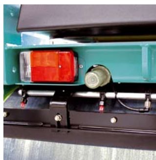
Filtration multiple du circuit d'arrosage
