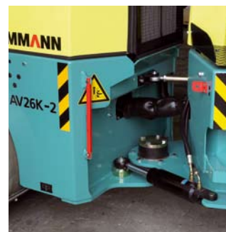
Articulation oscillante revêtue de téflon, graissée à vie
